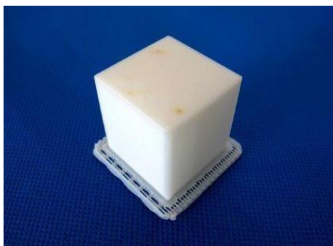
模型：30×30×30mm 成型层厚：0.2mm
