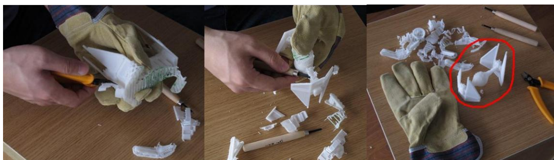
(图 52: 移除支撑材料步骤)
