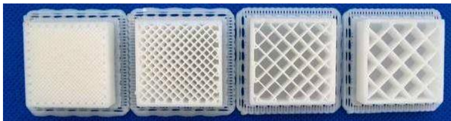
(图 49, 设置不同的内部支撑密度)
