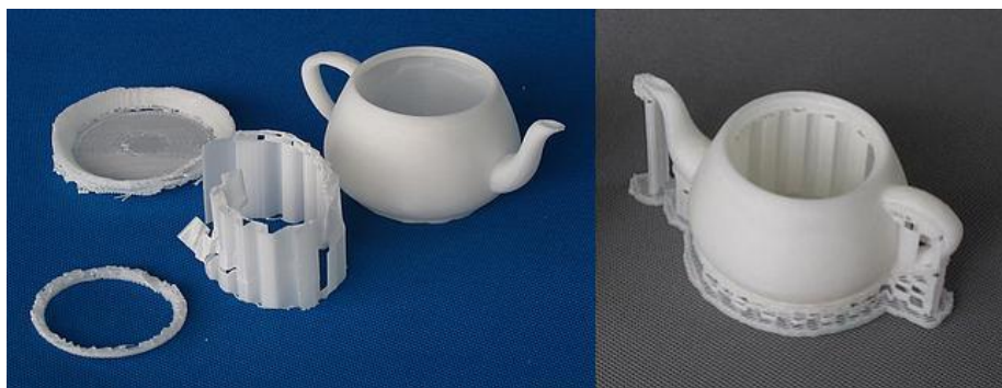
(图 51: 移除支撑材料)
